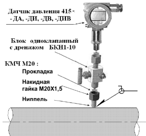
Рисунок Д.1 - Монтаж датчиков моделей 5ХХ3, 7ХХ3, 8ХХ3 и 8ХХ8
